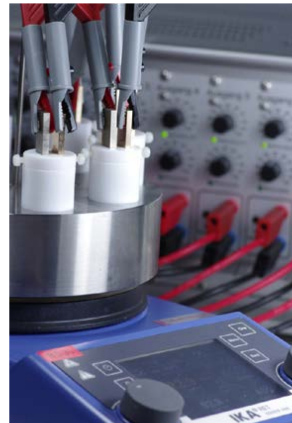
Bis zu acht verschiedene Versuche können gleichzeitig in diesem Screening-Elektrolyseur durchgeführt werden. In jedem der kleinen Kunststoffbecher stecken zwei Elektroden. Foto/©: Carsten Siering, JGU
